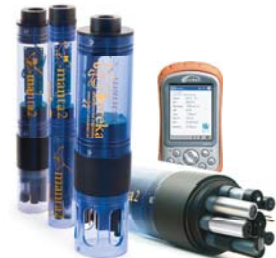
pH, ORP, DO(Optical), 전도도, 염도, 탁도, 클로로필a, 수위, 수심, 남조류, 로다민, \text{NH}_4^+ , \text{NO}_3^- , \text{Cl}^- , TDG, CDOM
