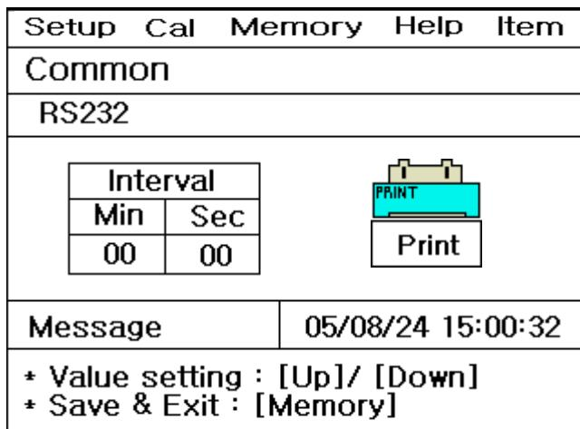
Move Key를 이용하여 Interval의 Min, Sec 항목으로 이동하여 시간 설정을 할 수 있고, Data-Log의 대상을 설정하는 항목으로 이동하여 Printer를 선택한다.
