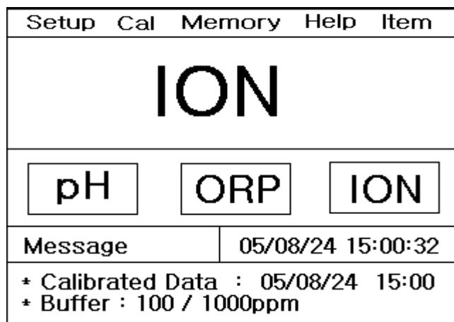
위와 같이 보정이 완료되면 보정을 본 날짜와 시간, 그리고 사용한 보정용액이 화면 하단 메시지 창에 표시가 된다. 전극을 증류수로 잘 세척한 후 ISA 가 첨가된 측정샘플에 이온전극을 넣고, Measure Key를 눌러 농도를 측정하면 된다.
