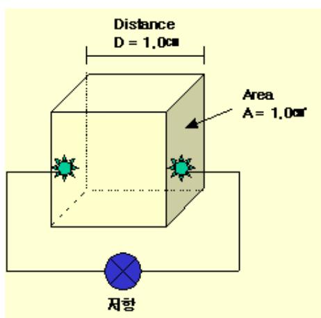
전도도 Cell 은 cell 의 형태, 위치, 전극의 크기에 따라 각각 자체의 cell 상수(Cell constant)를 가지고 있으며, 이 cell 상수는 전도도 표준액(KCl 용액)을 사용하여 정하거나 cell 상수가 알려진 다른 전도도 cell 과 비교하여 정할 수 있고 일반적으로 기기 설명서에 명시되어 있다.
