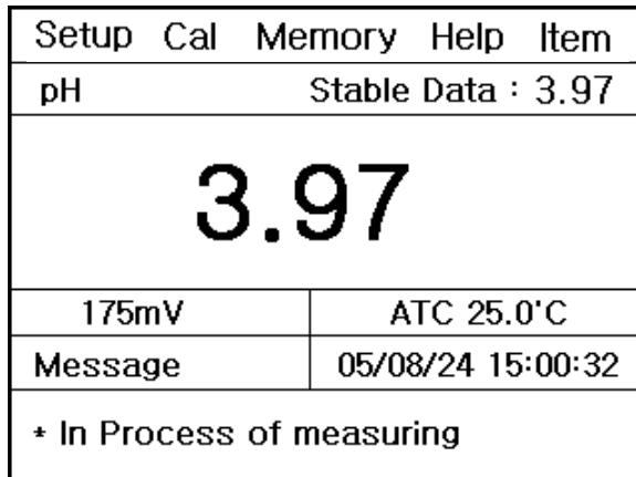
pH 측정 초기화면으로 이동하고자 하는 경우에는 Measure Key 를 누르고, 측정값을 저장하고자 하는 경우는 Memory/Out Key 를 누르면 된다.
