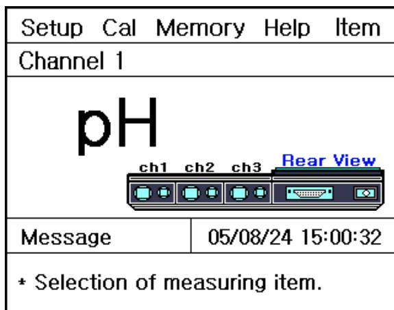
위의 화면에서 측정항목을 변경하고자 하는 경우는 Enter Key 를 눌러 초기화면으로 이동하여 항목을 변경할 수 있고, 선택한 항목을 측정하고자 하는 경우는 Measure Key 를 누르면 된다.
