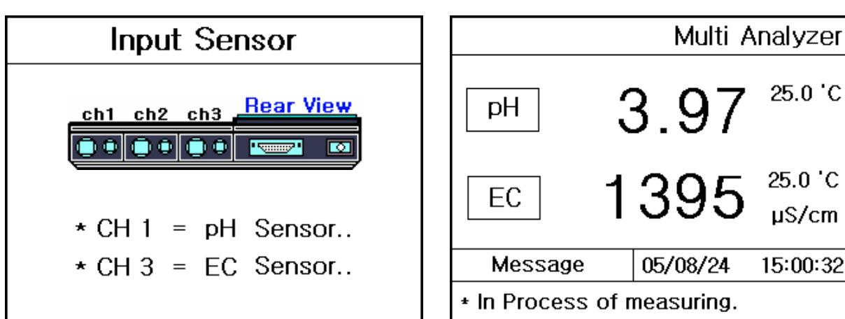
센서의 연결여부를 표시하는 왼쪽 화면이 잠시 표시되고, 각 항목의 측정값들이 오른쪽 화면과 같이 표시가 된다. 측정항목을 바꾸거나 초기화면으로 이동하고자 하는 경우에는 Measure Key 를 누르고, 측정값을 저장하고자 하는 경우는 Memory/Out Key 를 누르면 된다.
